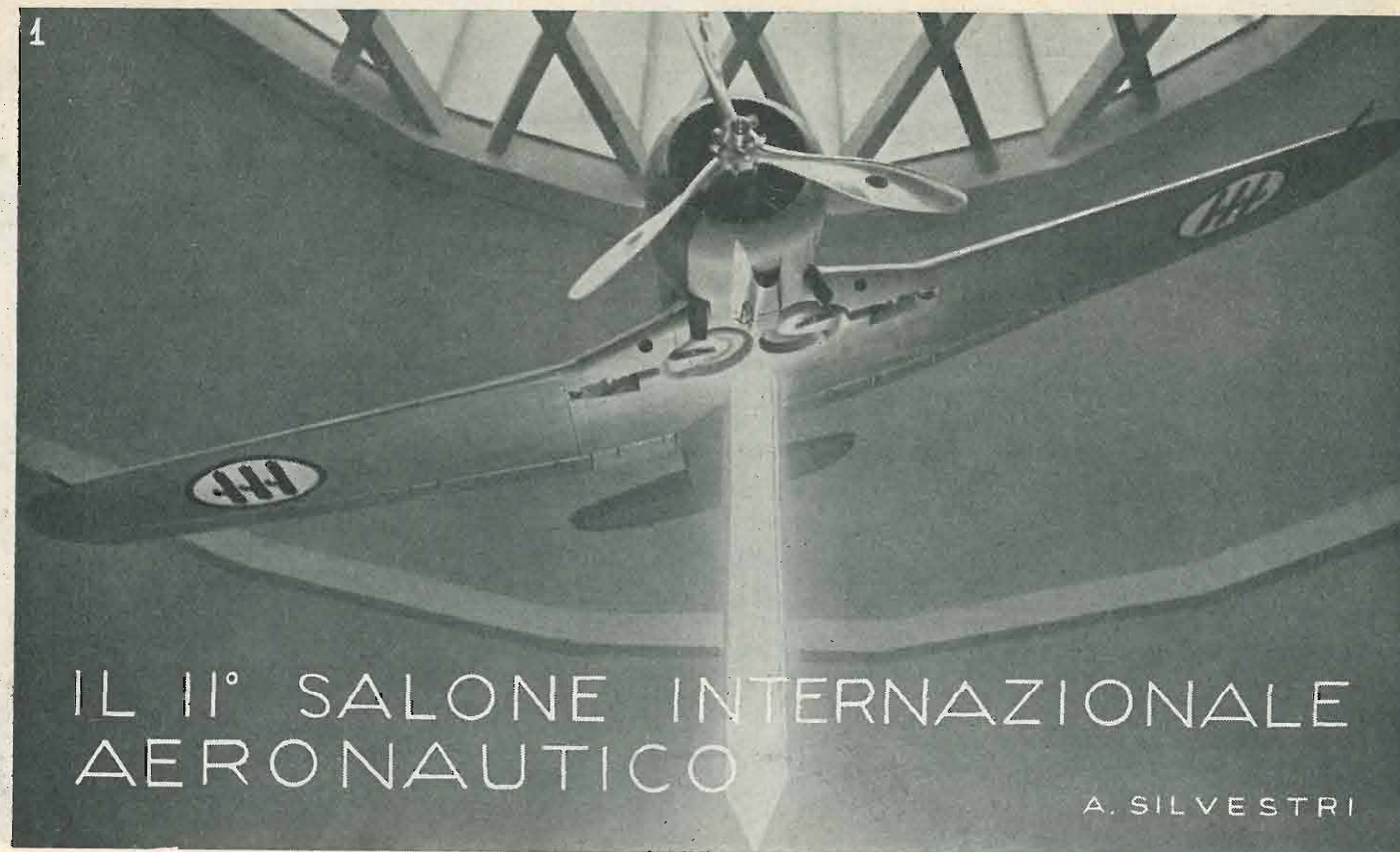
1. Il Fiat G.50 da caccia, monoplano interamente metallico, con un motore da 950 C.V., carrello rientrabile, quattro mitragliatrici, può raggiungere 460 chilometri all'ora a 3800 metri di quota.
